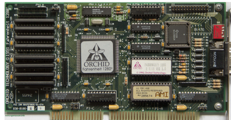
Figura 17.15: Orchid Fahrenheit 1280 (1992). Una de las primeras tarjetas que incorporaban aceleración gráfica 2d.
