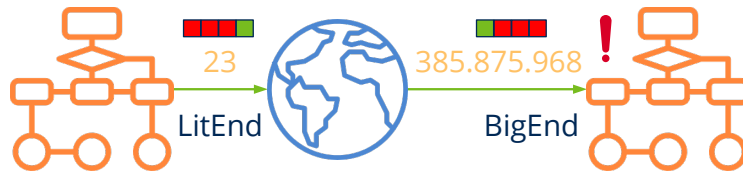
Figura 15.22: Debemos tener en cuenta el endianness a la hora de compartir datos entre máquinas de diferente arquitectura.
