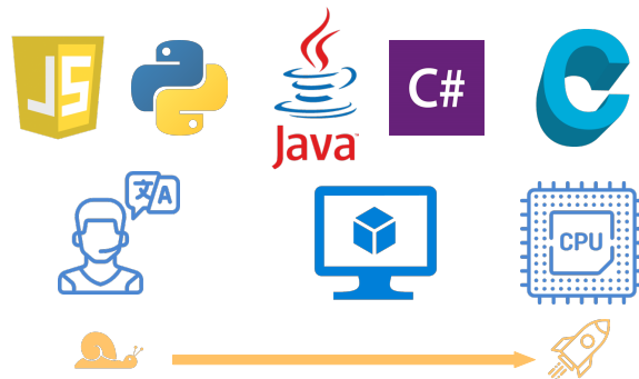
Figura 2.4: Intérprete, máquina virtual y código binario. Cuanto más nos acercamos al lenguaje máquina, mayor rendimiento obtendremos del software.
